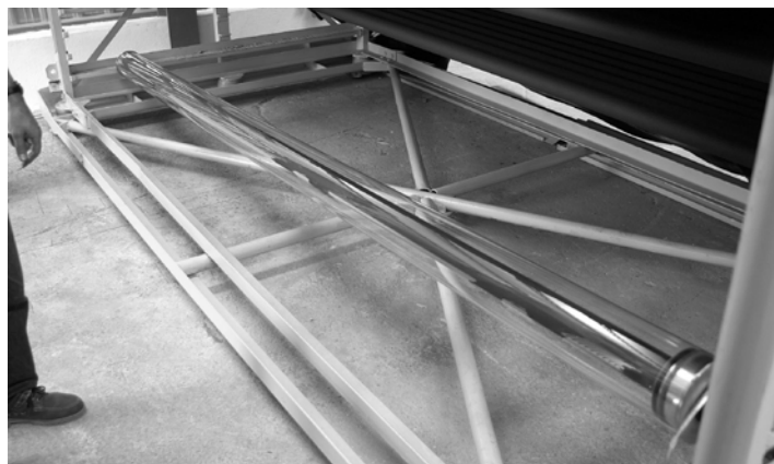
Figura 5: Tubo receptor sin vacío desarrollado en la PSA para captadores tipo Eurotrough.
