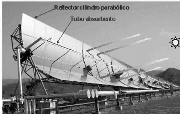
Figura 4. Captador cilindro parabólico típico
