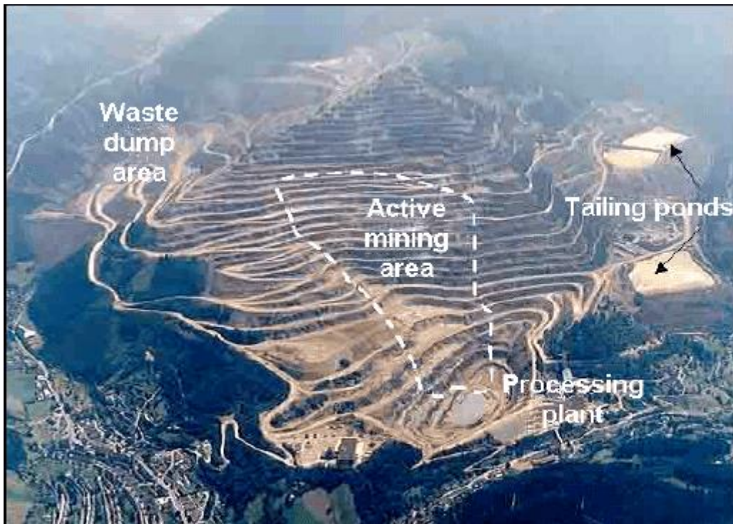
Figura 1: Diferentes áreas de explotación, procesamiento y almacenamiento de residuos en una explotación minera
