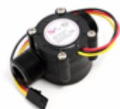
Los caudalímetros están constituidos por una carcasa plástica estanca y un rotor con paletas en su interior. El fluido al atravesar el interior del sensor hace girar el rotor.
