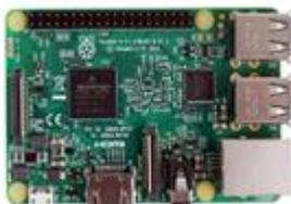
Raspberry PI es una placa computadora de bajo coste que funciona como un mini ordenador, en este caso recibiendo las mediciones de los sensores y enviándolos al servidor en la nube.
