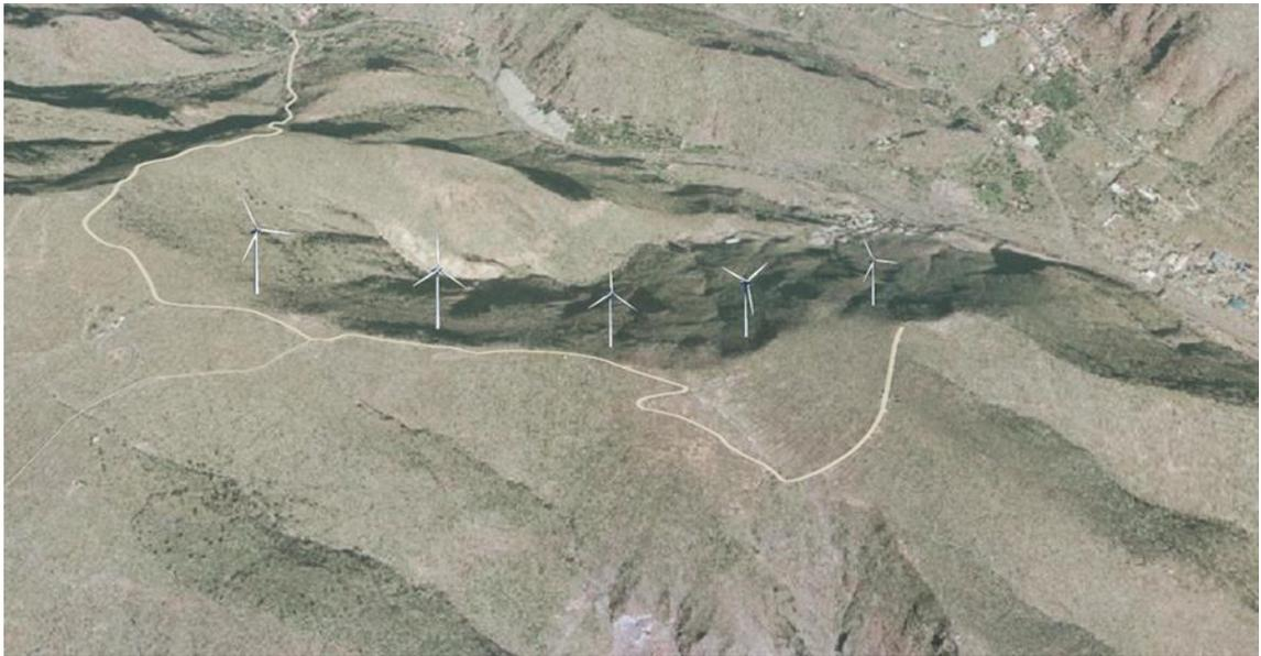
Ilustración 56: Situación de los aerogeneradores, distanciados 3 diámetros.
