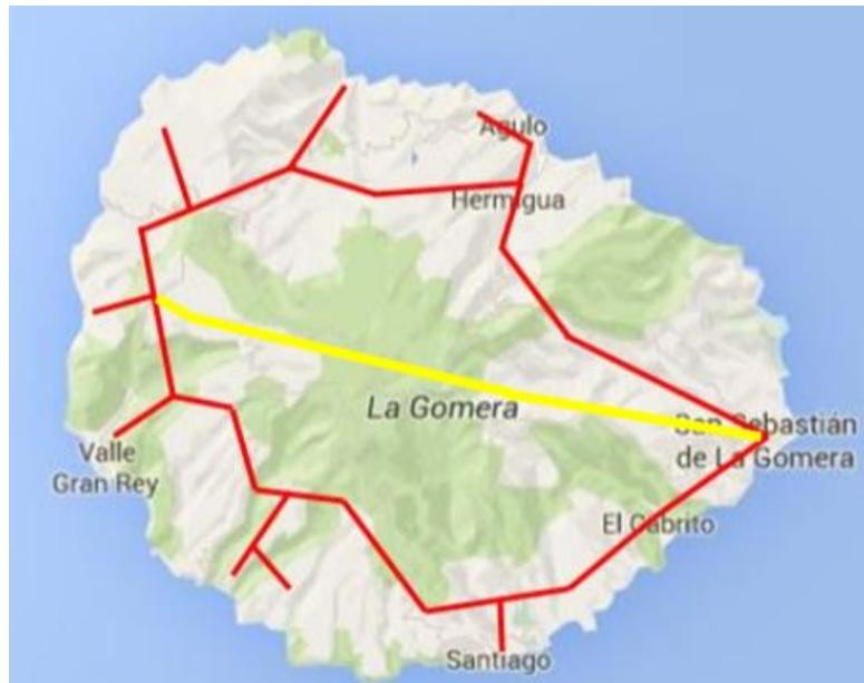
Ilustración 87: Futura nueva red de distribución (66 kV) (amarillo) [Elaboración propia a partir de datos de REE]
