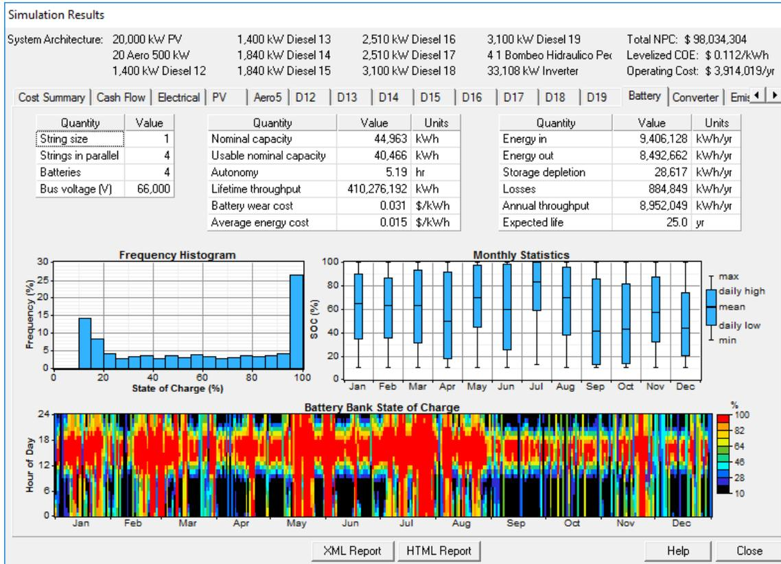
Ilustración 77: resultado de la simulación del sistema hidráulico como batería.
