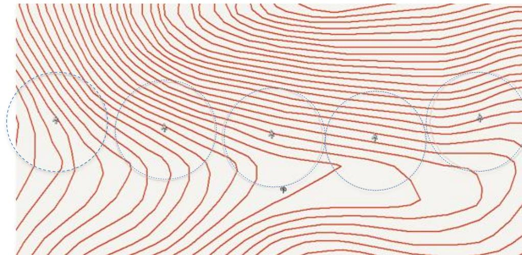
Distribución aerogeneradores en el WASP – Separación 3 diámetros
