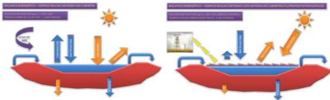
Figura 8.20. Balance energético: balsa sin cubierta y balsa con cubierta flotante.
