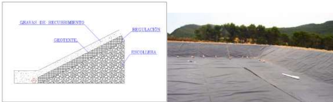
Figura 9.13. Esquema e imagen de balsa impermeabilizada mediante láminas.
