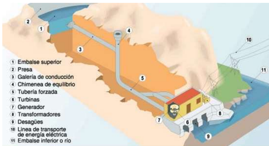
Figura8.1. Esquema de central hidroeléctrica de bombeo.
