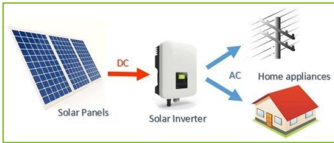
Imagen 27: Sistema fotovoltaico “On-Grid”. Fuente: Google images.
