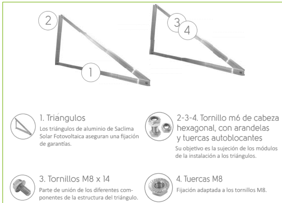
Imagen 11: Estructuras individuales. Fuente: SACLIMA Solar Fotovoltaica.
