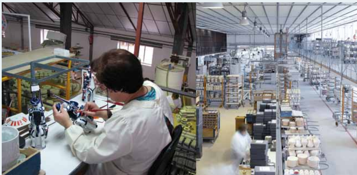
Decoración Aplicación a pincel de una pieza vitrificada ( www.sargadelos.com )
