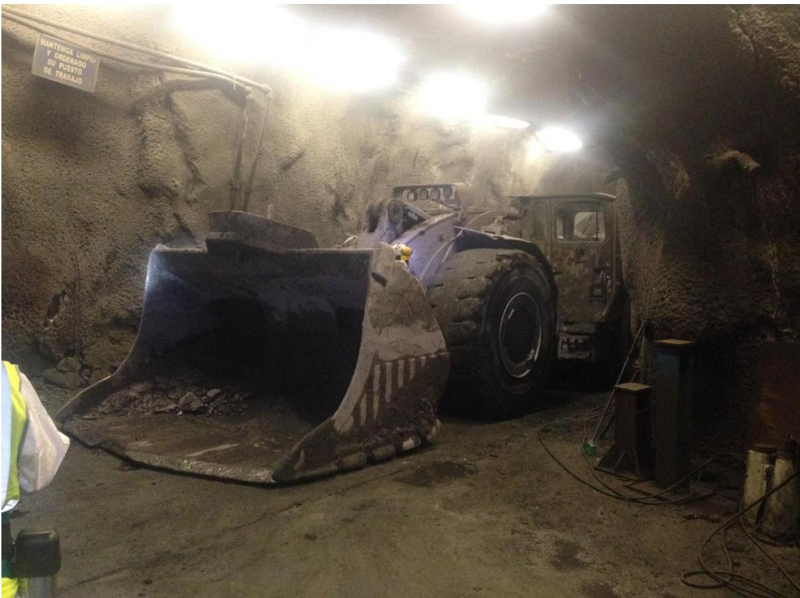
Pala en mantenimiento reactivo dentro de la mina
