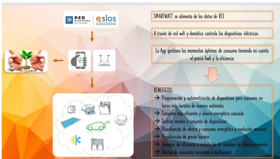
Figura 5. Funcionamiento aplicación SmartWatt Fuente: Elaboración propia
