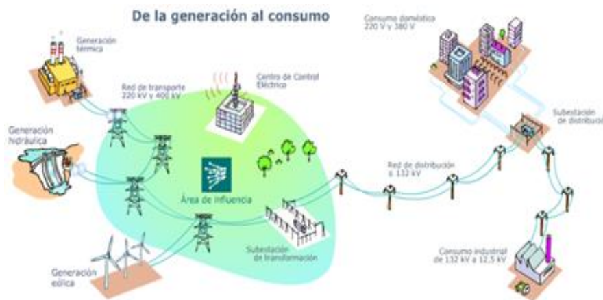
Figura 7 Esquema general de la red eléctrica.
