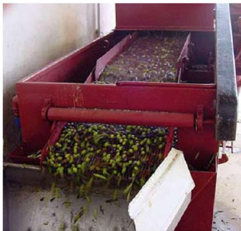
*Figura 3-9. Lavadora de aceitunas en funcionamiento (7)*
