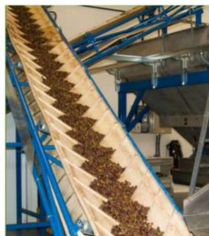
*Figura 3-10. Transporte de oliva al molino mediante cinta (7)*
