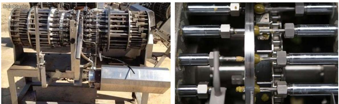
*Figura 3-17. Deshuesadora de entamadora (izquierda) y detalle de deshuesadora (derecha) (7)*
