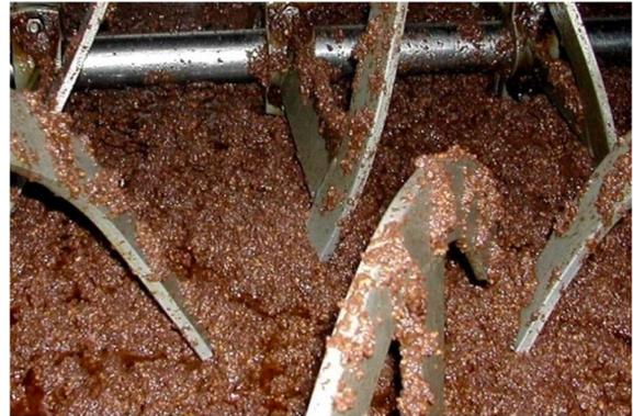
*Figura 3-12: Batidora de almazara (izquierda) y batido de la pasta de aceitunas (derecha) (7)*
