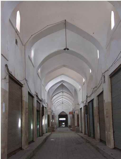
Imagen 21: Ventilación cruzada en un mercado de Irán
