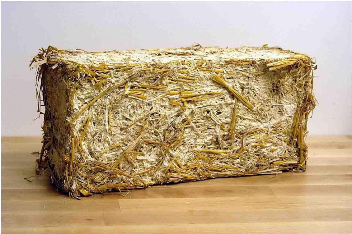
Bloque de paja compactado con mortero de adobe
