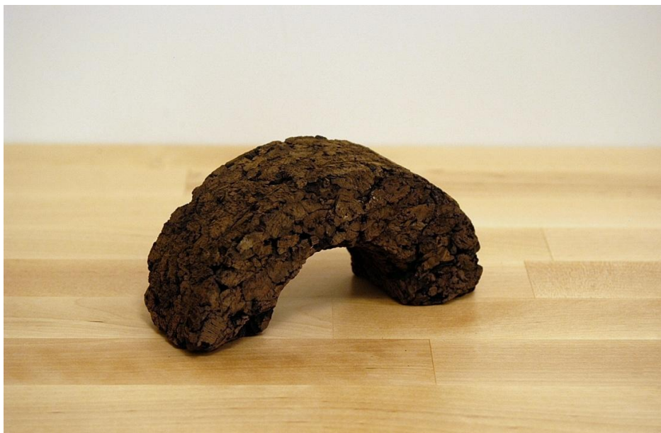
Corcho aglomerado fino de mayor densidad para evitar ruidos de impacto, vibraciones y puentes térmicos y acústicos.
