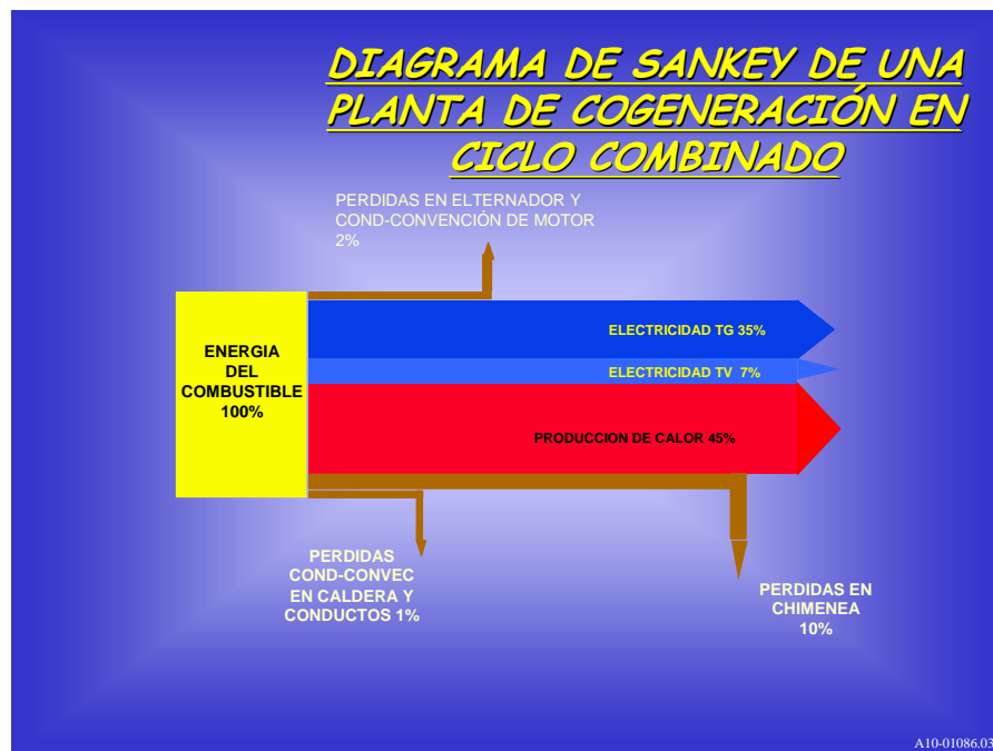
FIG. 7.2. DIAGRAMA DE FLUJO ENERGÉTICO DE UNA PLANTA DE COGENERACIÓN EN CICLO COMBINADO
