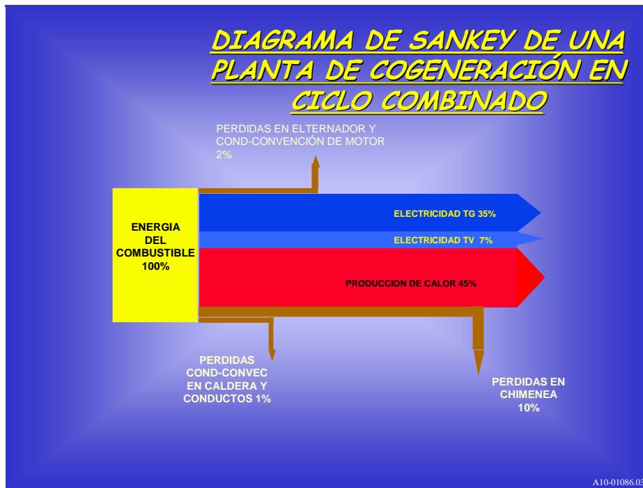
Fig. 1.2 Diagrama de Sankey de una planta de cogeneración en ciclo combinado
