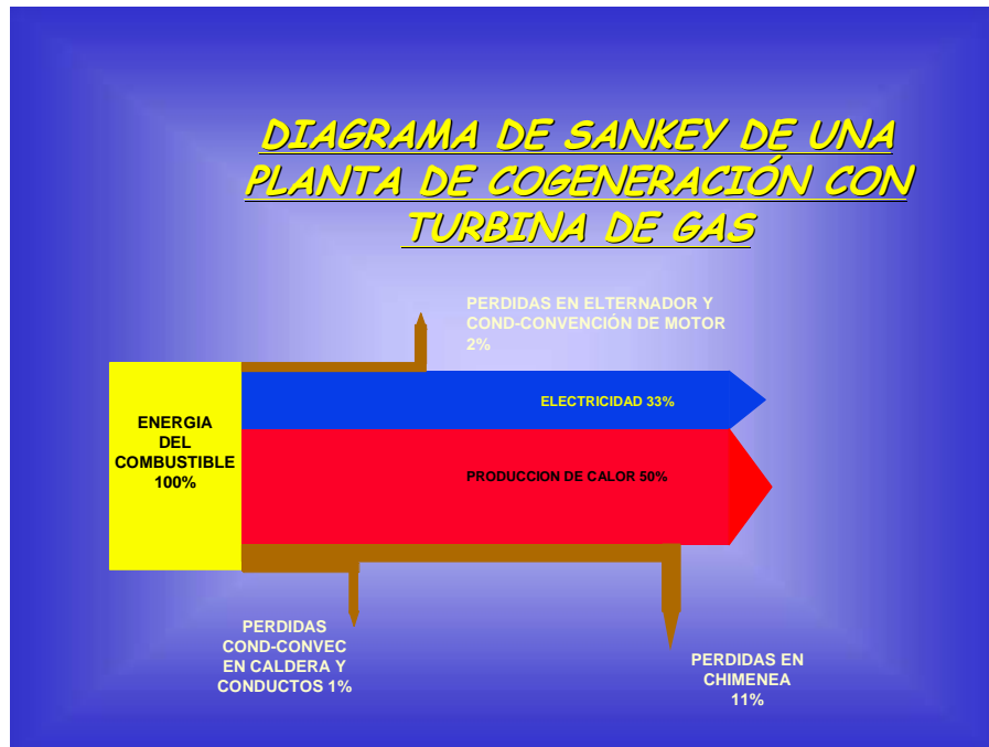
Fig. 1.7. Diagrama de sankey de planta de cogeneración con turbina de gas
