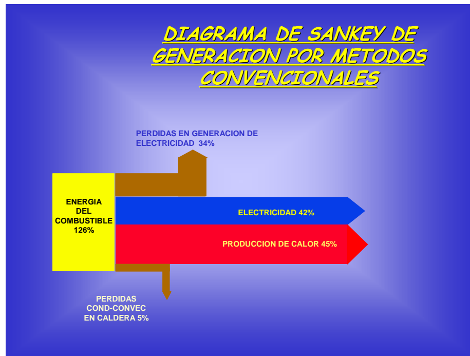
Fig. 1.3. Diagrama de Sankey de generación de energía a nivel nacional
