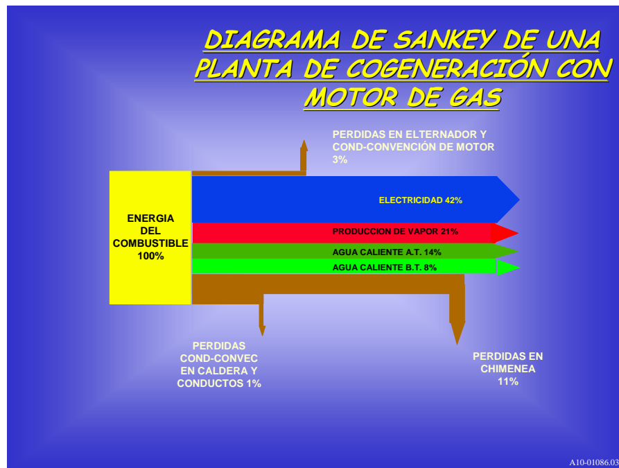
FIG. 7.3. DIAGRAMA DE FLUJO ENERGÉTICO DE UNA PLANTA DE COGENERACIÓN CON MOTOR DE GAS
