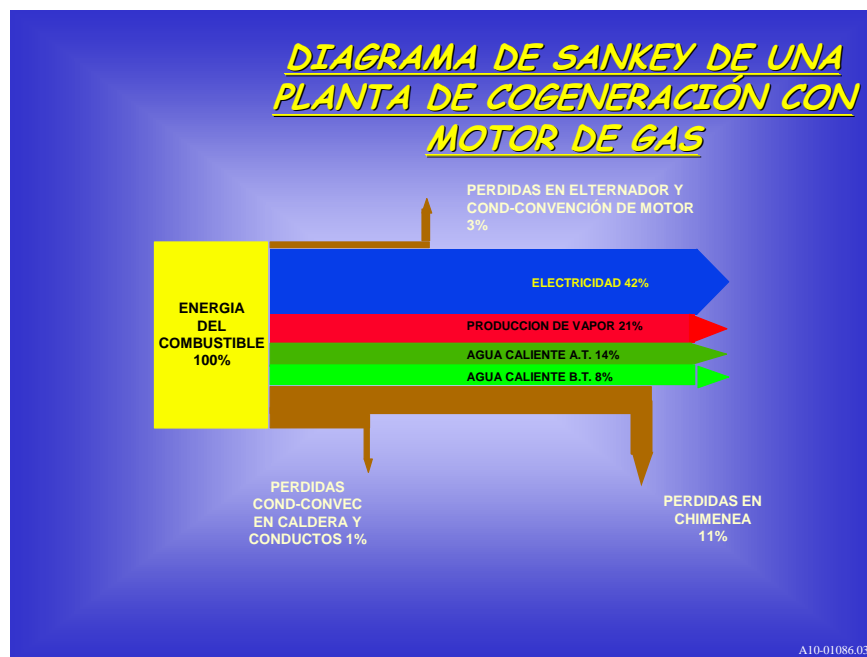
Fig. 1.5. Diagrama de sankey de planta de cogeneración con motor de gas
