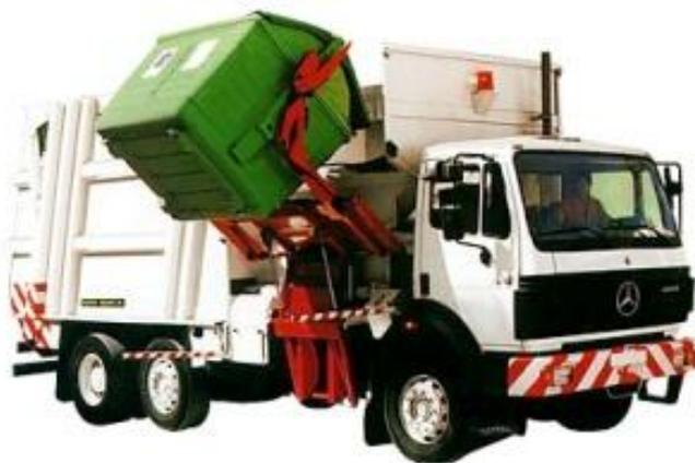
El proceso de carga y descarga de los contenedores está totalmente automatizado y controlado en todo momento por el conductor, única persona a bordo del vehículo, a través de varias cámaras de circuito cerrado de televisión dispuestas en diferentes lugares estratégicos del vehículo.
