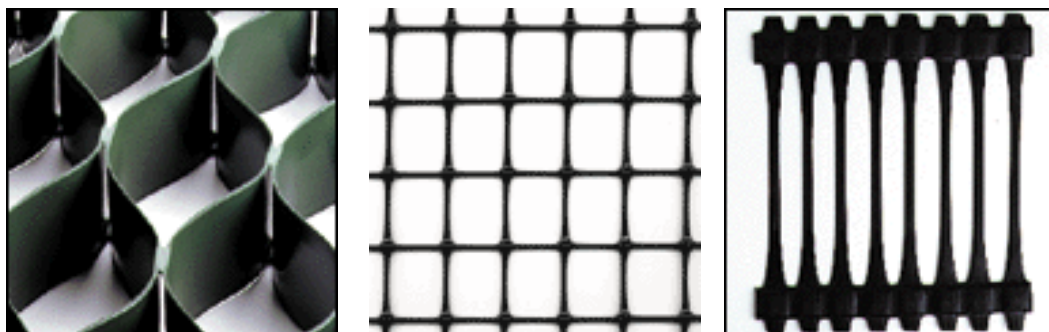
Figura 4.10: Ejemplos de geoceldas y geomallas
