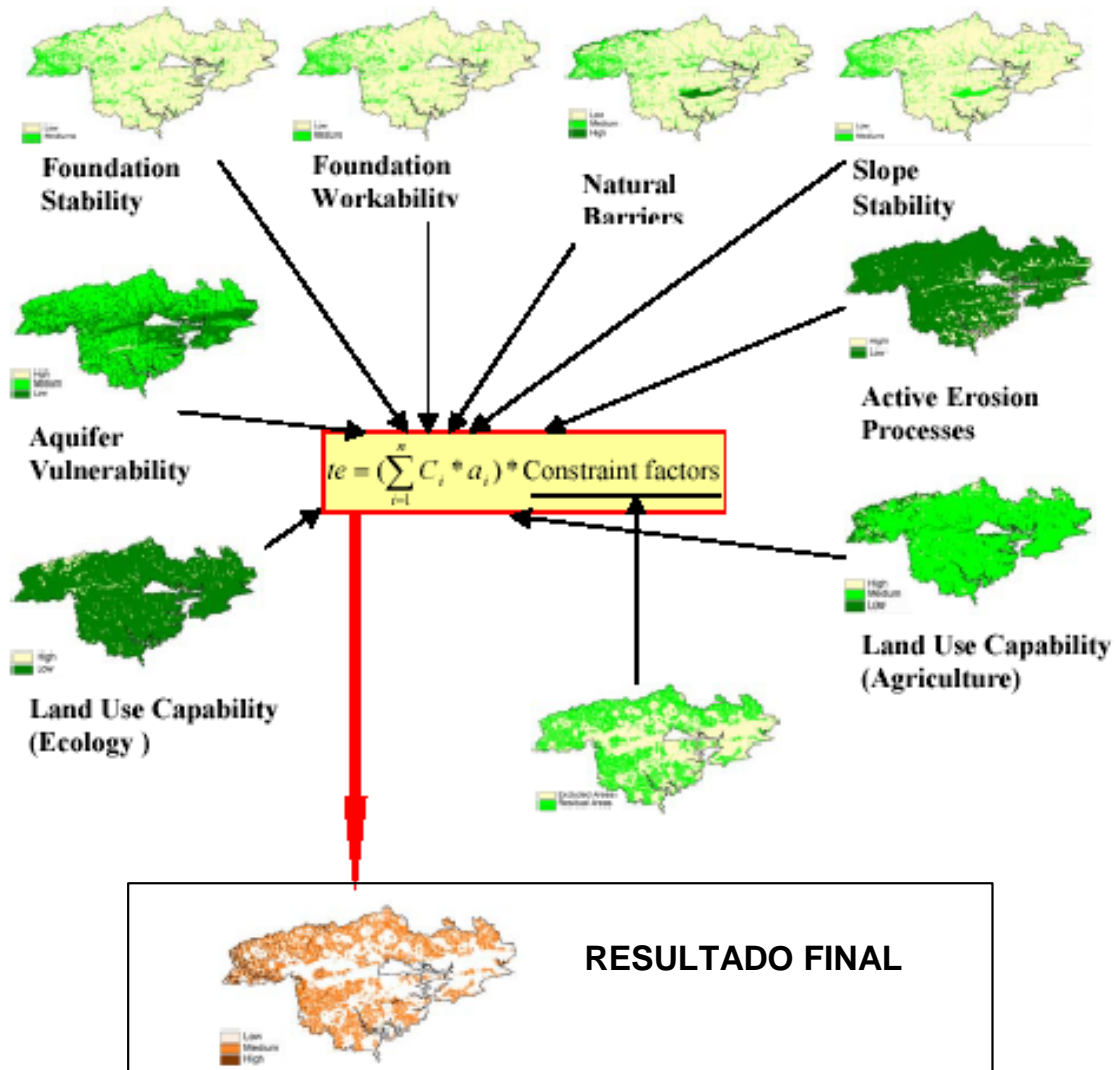
Fig. 4.4: Representación gráfica del modelo de ponderación de áreas residuales
