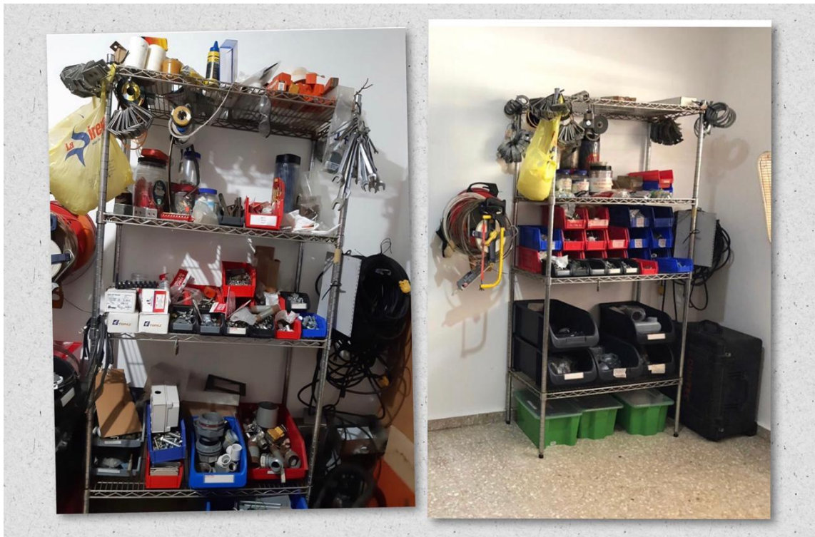
Visual de una parte del almacén antes y después de la aplicación de 5S
