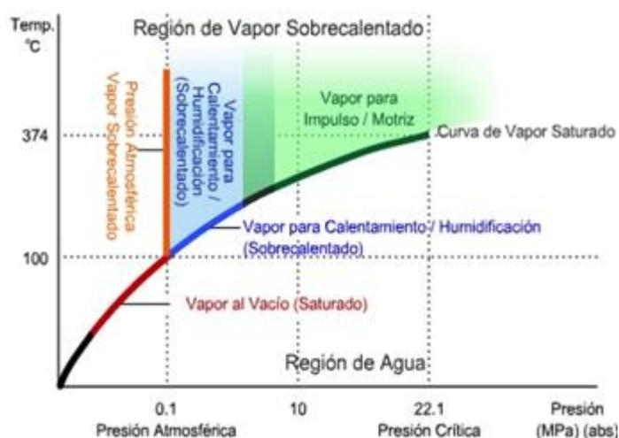
Figura 13: Tipo de vapor empleado en la industria
