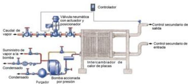
Figura 19: Unidad de intercambio de calor y sistema de control
