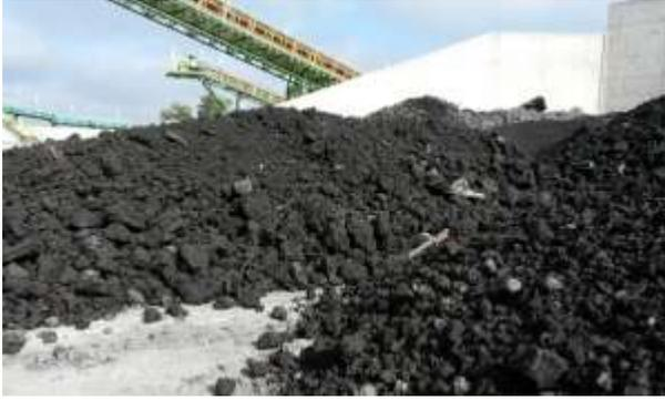
Otro convenio sobre Valorización de Escorias Siderúrgicas procedentes de Horno Eléctrico como árido en la fabricación de Mezclas Bituminosas cuyo objetivo es estudiar la idoneidad de las escorias siderúrgicas como áridos en la fabricación de mezclas bituminosas convencionales para diseñar y desarrollar fórmulas de trabajo del tipo de mezcla convencional, que se estime.
