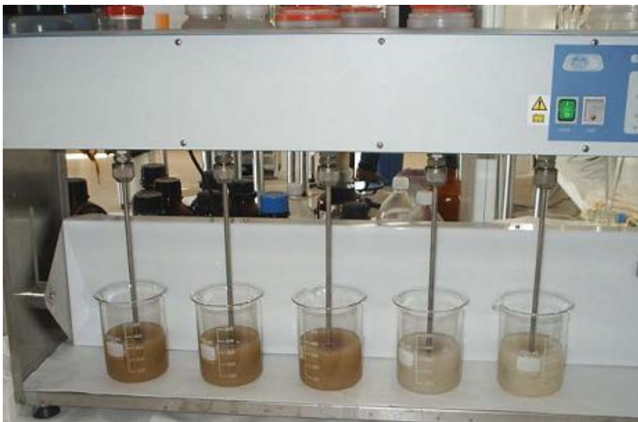
Figura 13: Ensayo Jar Test
