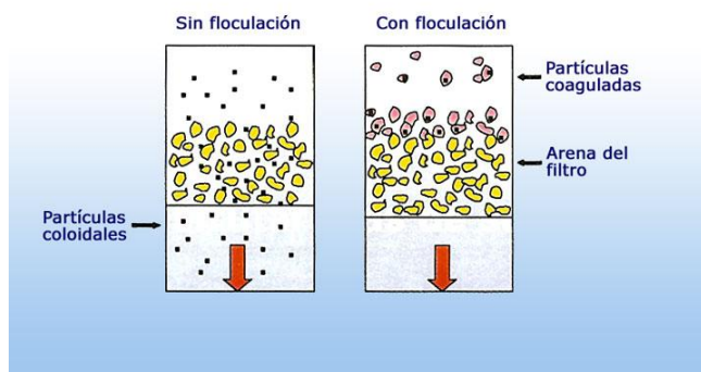
Figura 12: Principio de la floculación
