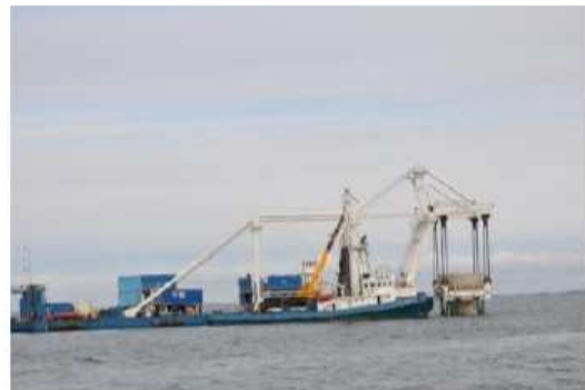
Ilustración 7. Transporte e instalación de una cimentación de gravedad
