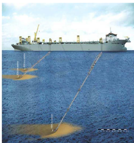
Ilustración 15. Instalación del cable submarino de evacuación mediante Dragado.
