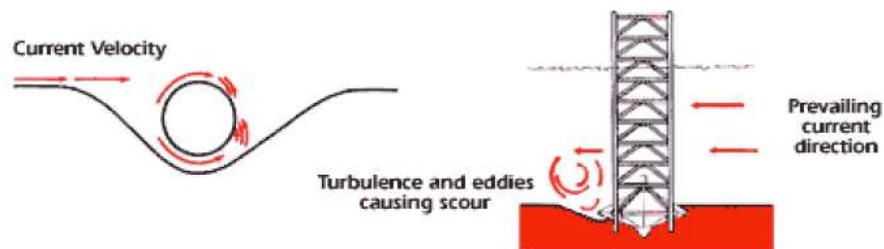
Ilustración 13. Proceso de erosión en la base del aerogenerador
