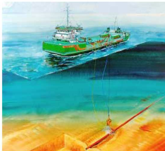
Ilustración 14. Instalación del cable submarino de evacuación mediante “Trenching”
