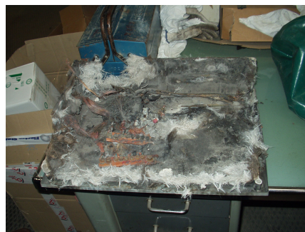
FIGURA 9.11: Efectos del funcionamiento de un diseño defectuoso de una caja de protecciones que incluye varistores.
