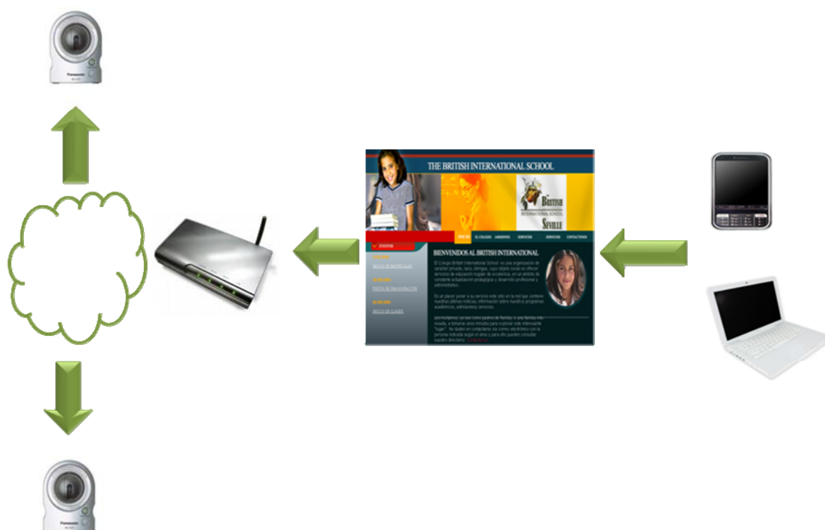
Arquitectura del sistema de videocontrol vía IP
