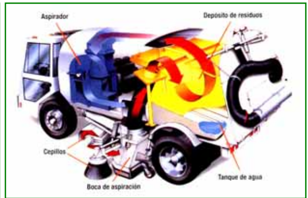
Esquema de funcionamiento de la barredora de arrastre y de la barredora de aspiración
