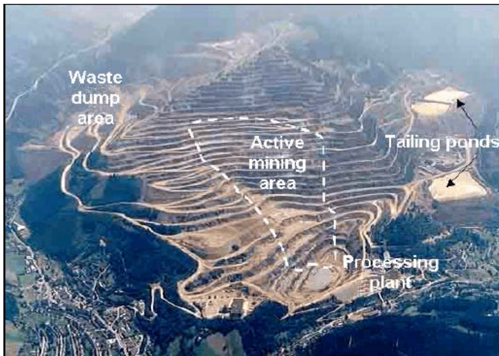
Figura 2.1.- Diferentes áreas de explotación, procesado y almacenamiento de residuos en una explotación minera
