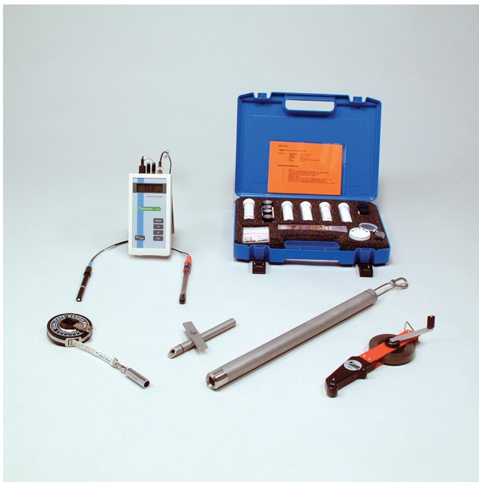
Equipo básico de análisis en campo: tomamuestras bailer, sonda hidronivel, pH-metro portátil y reactivos
