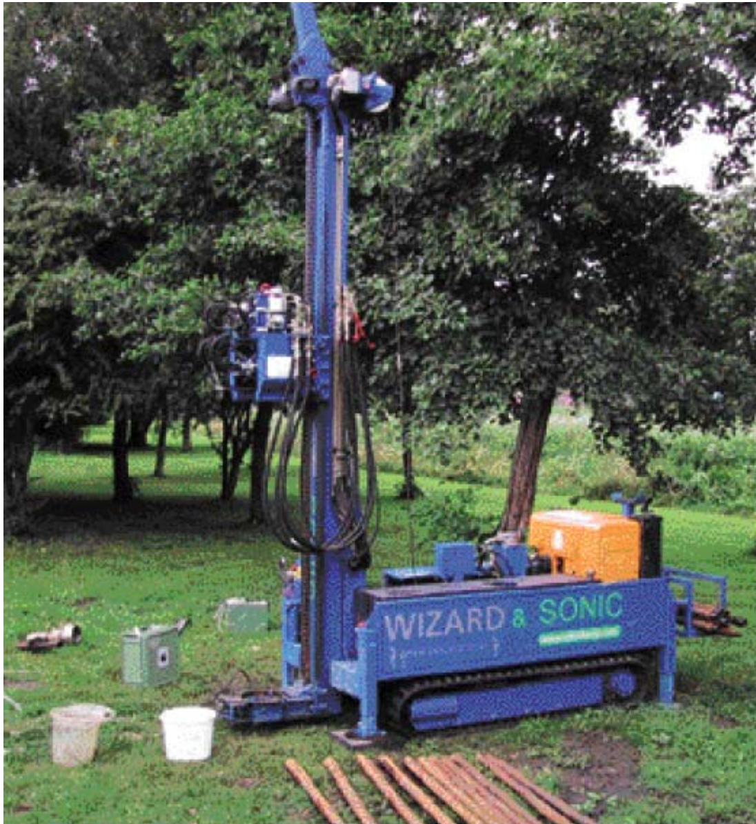
Sondeos mecánicos. Equipo de perforación sobre orugas
