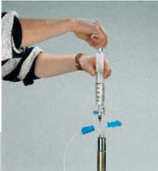
Toma de muestra mediante jeringa
