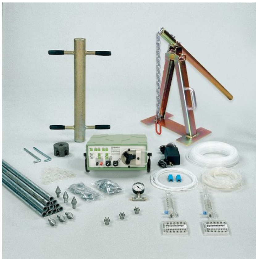
Equipo básico de perforación y muestreo de aire intersticial del suelo: sondas de punta perdida, bomba peristáltica, tubería flexible, jeringas y accesorios
