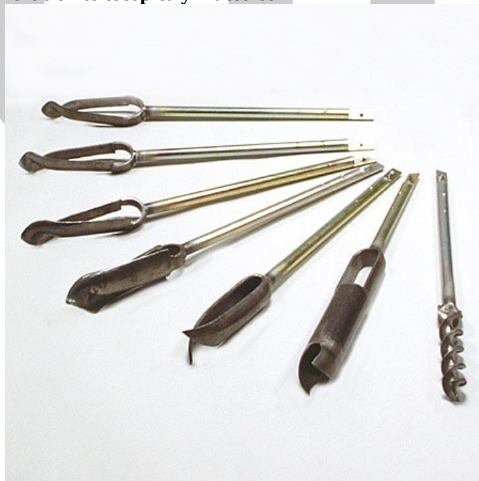
Sondas de perforación manual: cucharas Edelman, cucharas para gravas, cuchara Riversalpe, barrena helicoidal
