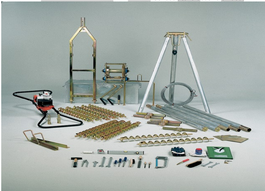
Equipo básico de sondeos ligeros con barrena helicoidal: trípode, motor, barrenas, to-mamuestras cilíndricos y accesorios
