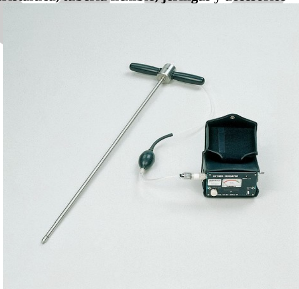
Medidor de oxígeno acoplado a sonda de punta perdida
