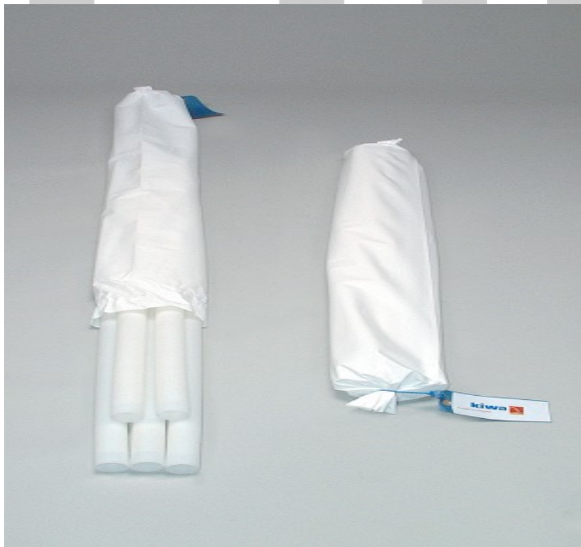
Tuberías piezométricas de polietileno de alta densidad
