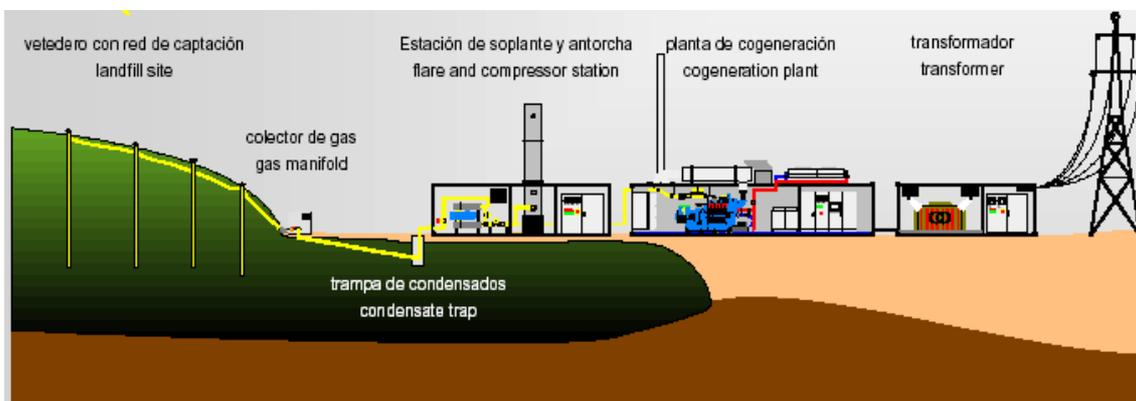
Fig. 6.5 :Instalación de generación eléctrica de biogás
