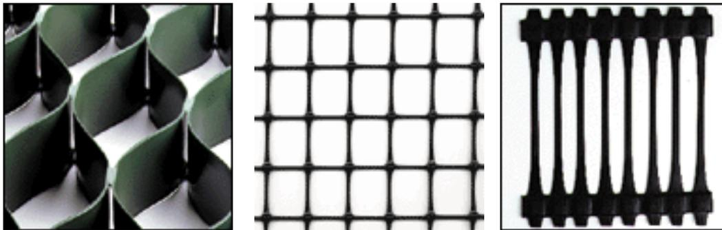
Figura 4.10: Ejemplos de geoceldas y geomallas
