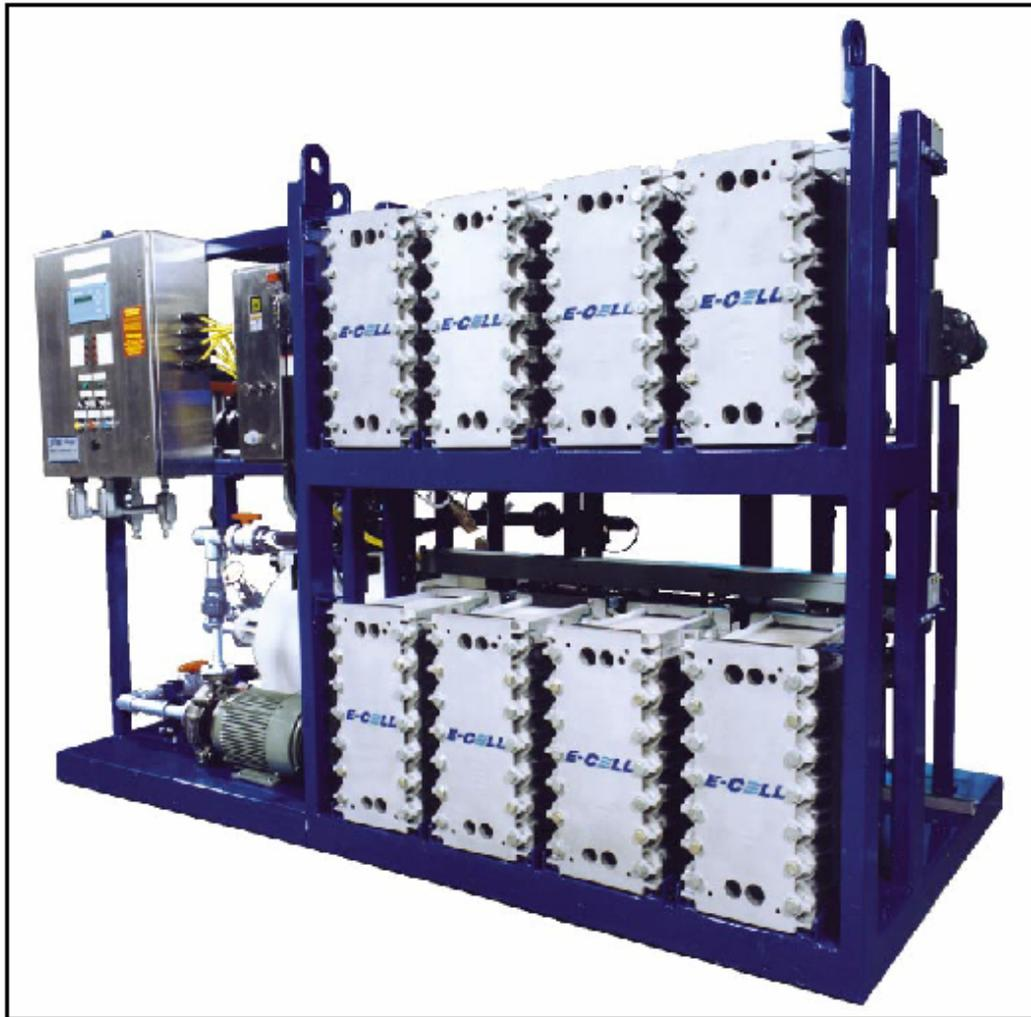
Al igual que con el resto de tecnologías, periódicamente (1 ó 2 veces al año) es necesario realizar la limpieza química de los módulos, para lo que se utiliza un tanque de limpieza que puede ser común a la OI.
