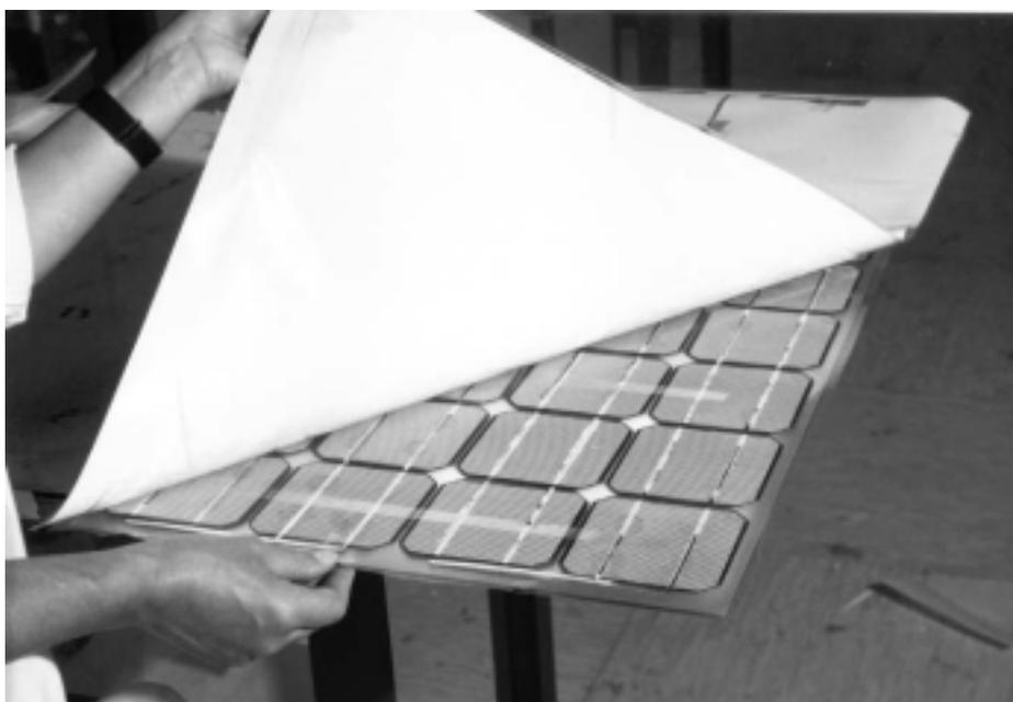
Figura 55. Imagen del proceso de fabricación de un módulo, en el que puede apreciarse la estructura del laminado.
