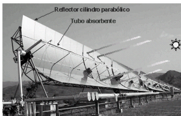
Figura 17. Captador cilindro parabólico típico
