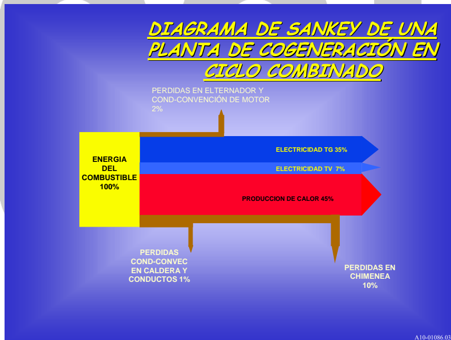
FIG. VII.2. DIAGRAMA DE FLUJO ENERGÉTICO DE UNA PLANTA DE COGENERACIÓN EN CICLO COMBINADO
