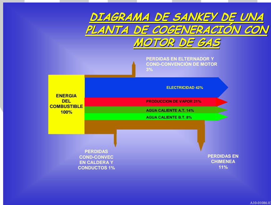
FIG. I.4. DIAGRAMA DE SANKEY DE PLANTA DE COGENERACIÓN CON MOTOR DE GAS
