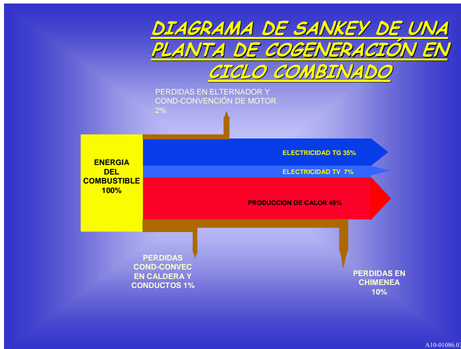
FIG. I.1. DIAGRAMA DE SANKEY DE UNA PLANTA DE COGENERACIÓN EN CICLO COMBINADO
