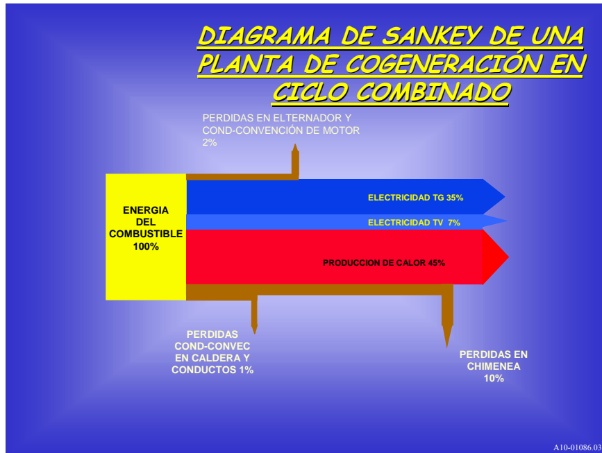
FIG. I.9. DIAGRAMA DE SANKEY DE PLANTA DE COGENERACIÓN EN CICLO COMBINADO CON TURBINA DE GAS
