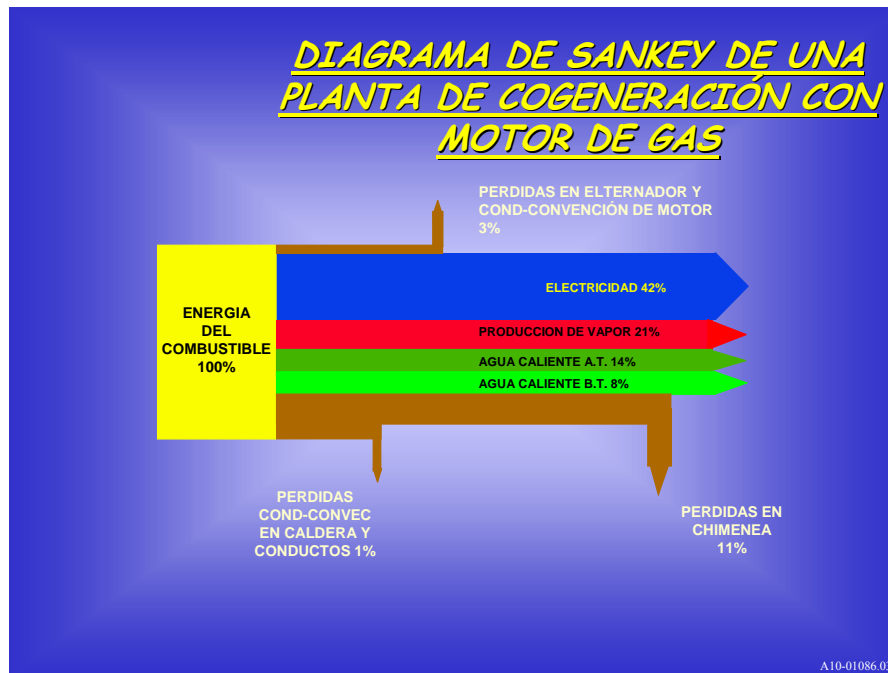
FIG. VII.3. DIAGRAMA DE FLUJO ENERGÉTICO DE UNA PLANTA DE COGENERACIÓN CON MOTOR DE GAS
