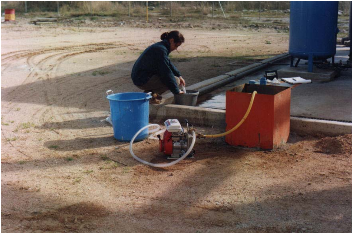
Figura 10.- Limpieza de un pozo de control de aguas subterráneas con bomba de aspiración con motor de gasolina
