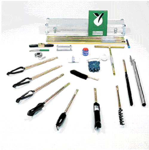
Figura 2a.- Perforación manual
