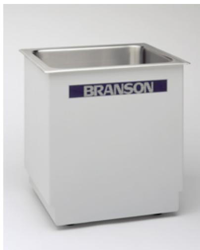
**Figura 20. Recipiente para oxidación química Branson DHA-1000.**
