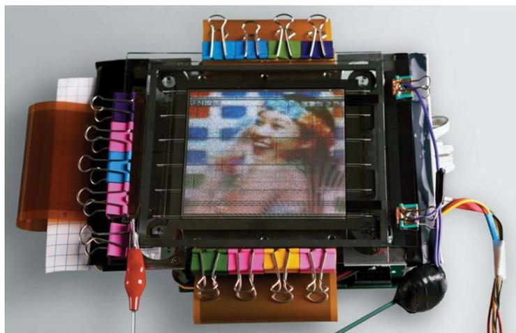
**Figura 5: Prototipo de pantalla de emisión de campo (field emisión display-FED) de Samsung fabricada con CNT. Fuente: [www.samsung.com](http://www.samsung.com)**
