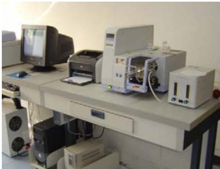
Figura 19. Equipo XRD Philips PW1820.
