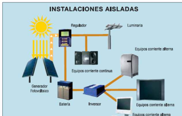
Figura 4. Esquema de una instalación fotovoltaica aislada
