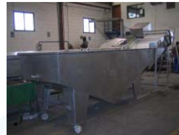
Silo de lavado de verdura
