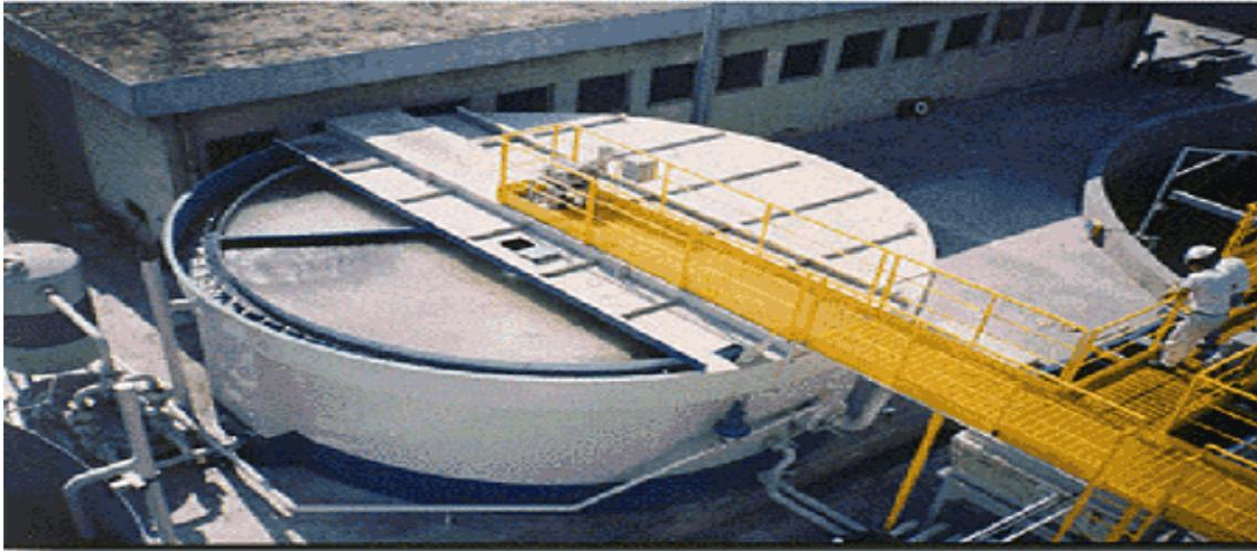
Figura 12: Flotador.
