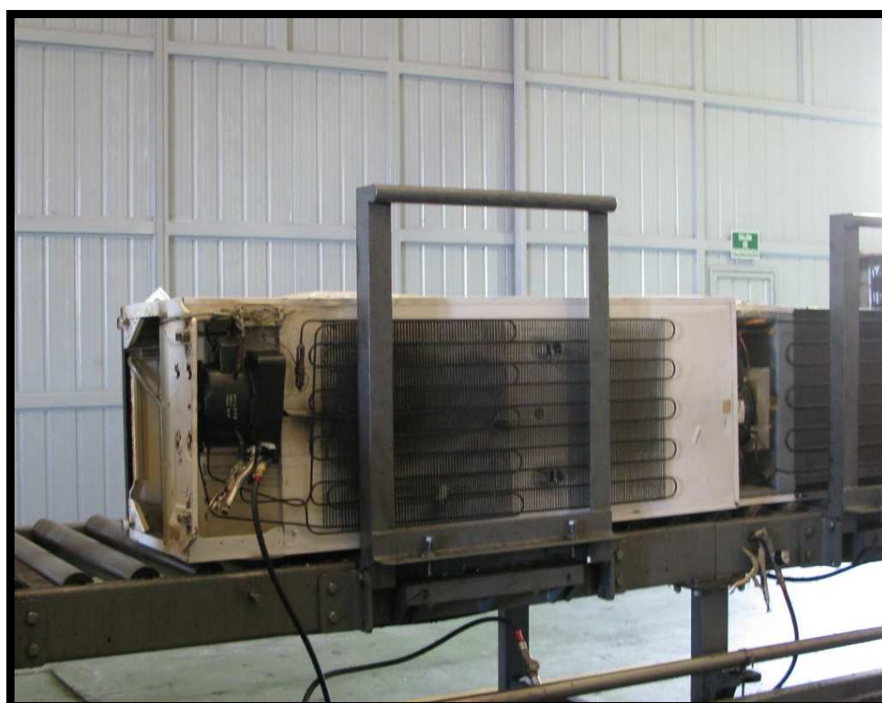
Fotografía 2 - Extracción de gases y aceites.
