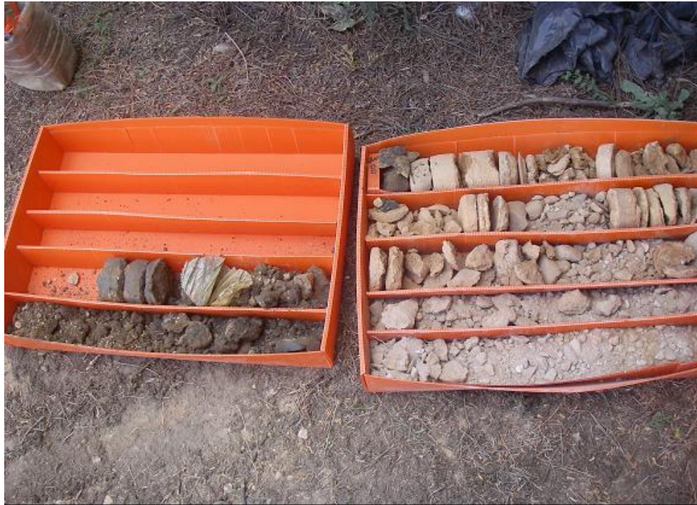
Figura 3.- Testigo litológico obtenido mediante sondeo mecánico a rotación
