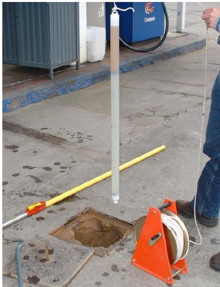
Figura 16. Muestreador manual (bailer) con presencia de fase libre
