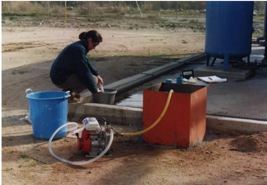
Figura 17.- Limpieza de un pozo de control de aguas subterráneas con bomba de aspiración con motor de gasolina
