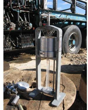
Fotografía nº 4. Dispositivos para control propiedades del lodo: balanza Baroid (densidad), Embudo Marsh (viscosidad) y Filtro-Prensa (cake).
