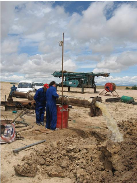
Fotografía nº 8. Aforador y tubo pitot para medición de caudales.
