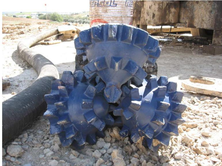
Fotografía nº 2. Tricono utilizado como útil cortante en el sistema “rotary”.
