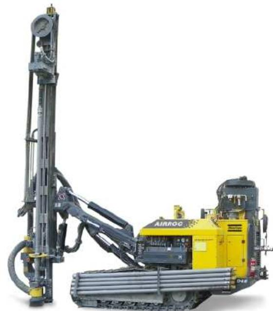
Figura nº 6. Funcionamiento del sistema de perforación a rotopercusión a circulación inversa y fotografía de una máquina de rotopercusión.
