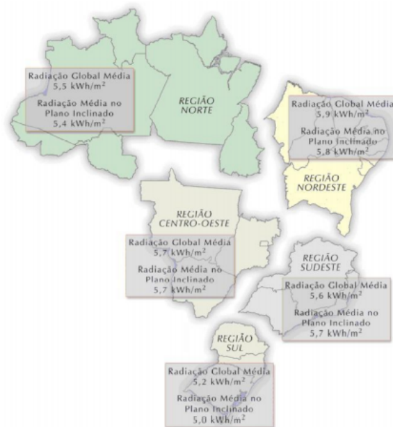
Promedio de radiación global en el plano horizontal e inclinado para cada región de Brasil
