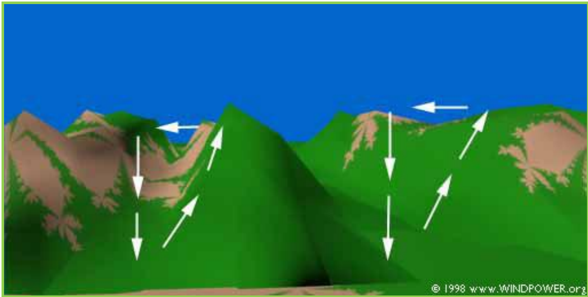
Figura 56: Efecto viento cañón producido en alta montaña
