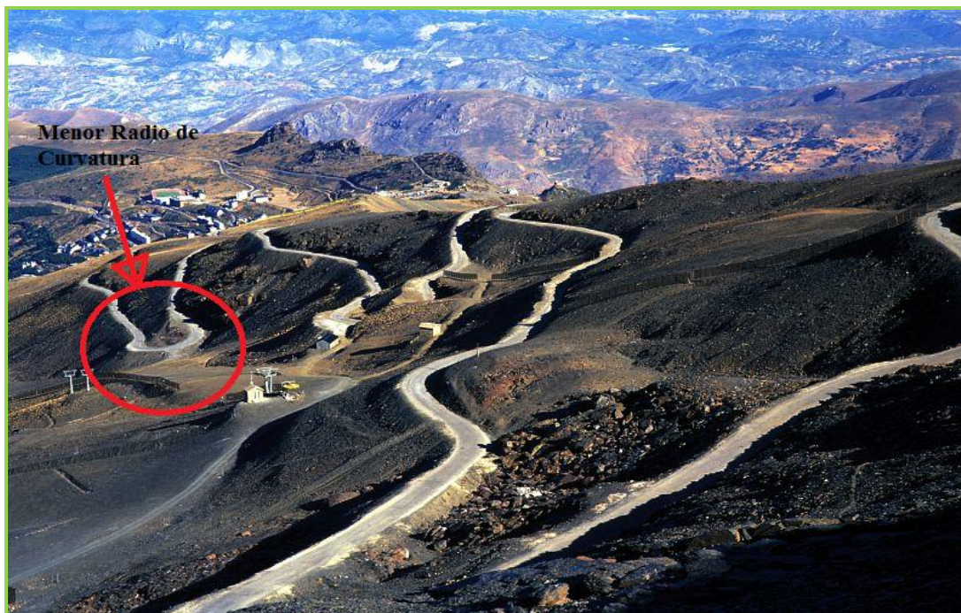
Figura 38: Detalle de giro menor radio de curvatura
