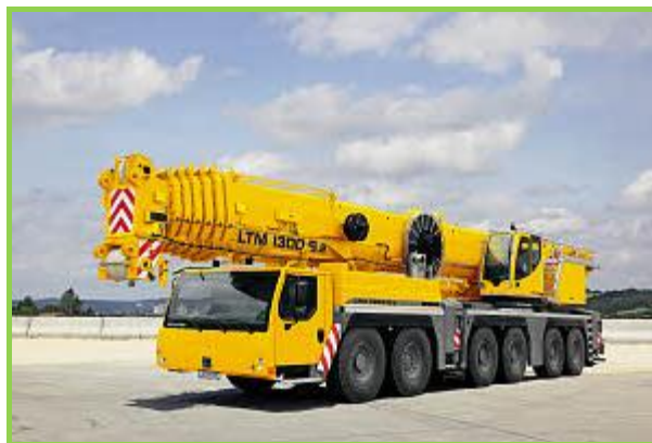
Figura 48: Grúa Liebherr LTM 1300-6.2 .
