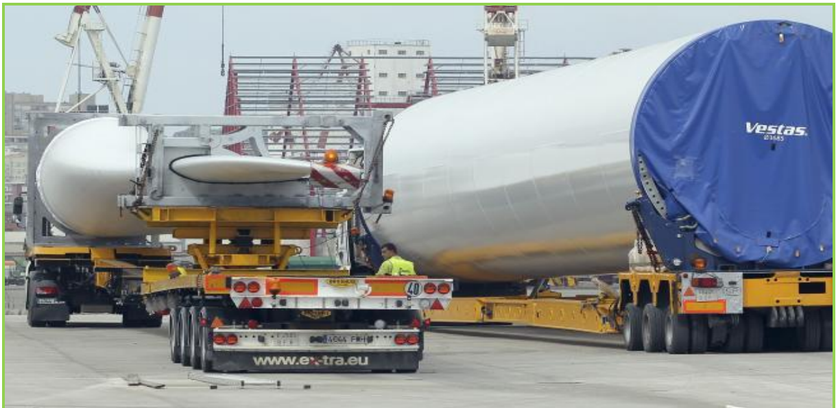
Figura 40: Transporte pala y torre
