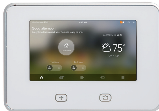
IMAGEN 20 Panel de control de una casa inteligente
