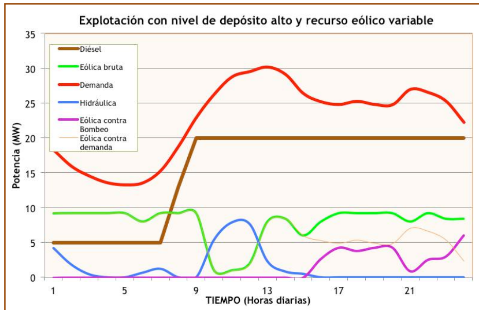
Figura 5.6 Explotación con depósito superior con capacidad elevado y recurso eólico variable. Fuente: elaboración propia
