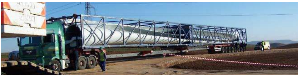
Figura 3.13. Transporte de las palas. Fuente: Javier Sanchís, documentación EOI
