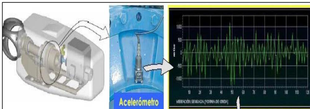
Figura 121. Análisis de vibraciones
