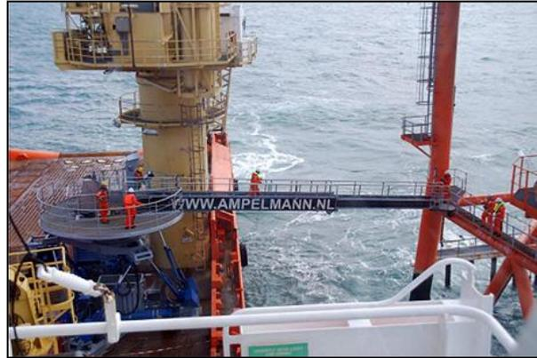
Figura 134. Plataforma de acceso tipo ampelmann.
