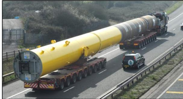
Figura 105. Transporte de pilotes hasta el puerto
