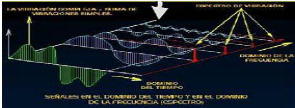
Figura 122. Análisis de vibraciones 2
