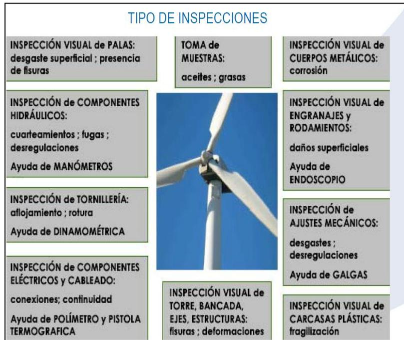
Figura 120. Tipos de Inspecciones
