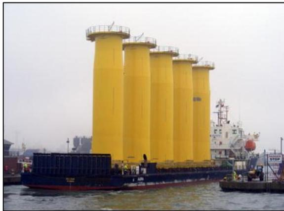
Figura 112. Transporte de la pieza de transición
