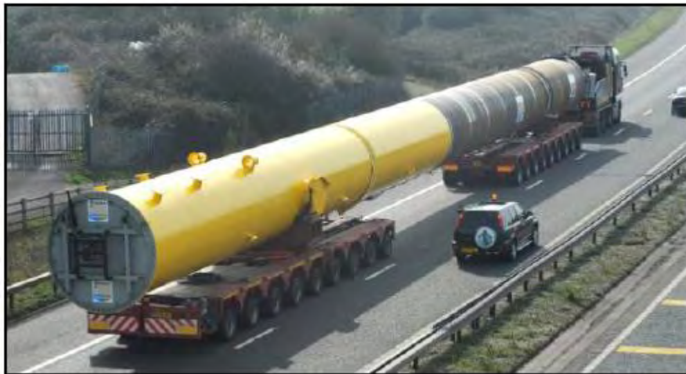
Figura 108. Transporte de pilotes hasta el puerto
