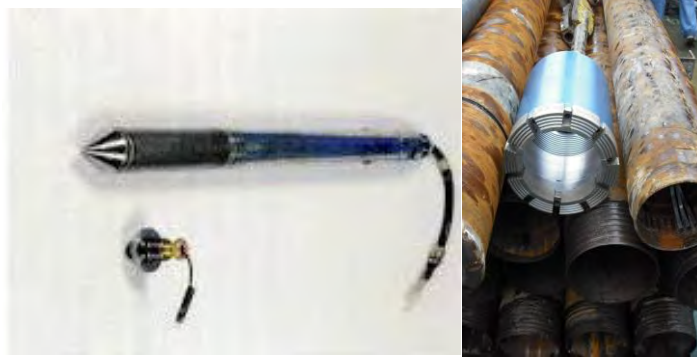
Figura 26. Piezocono/CPTU (Izquierda) y Sondeo mecánicos (derecha). (Fuente: AFS)
