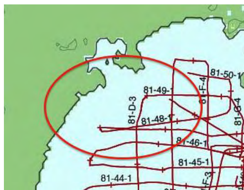
Figura 29. Estudios batimétricos del emplazamiento del parque eólico (Fuente: Geological Survey of Japan).
