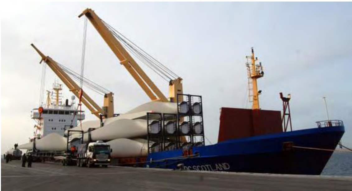
Figura 106. Estructura en celosía para elevación de palas
