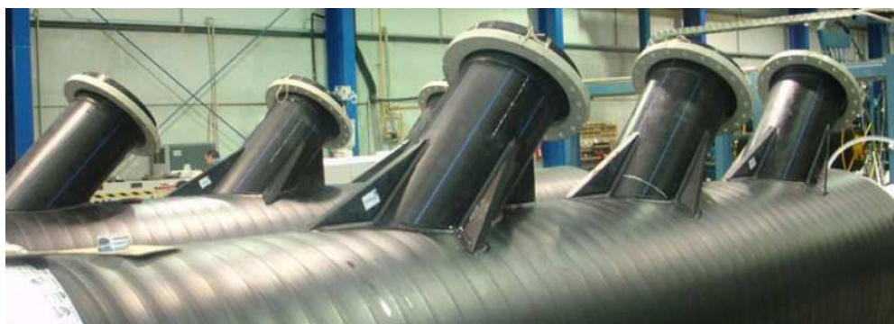
Figura 54: Difusores para el vertido de la salmuera
