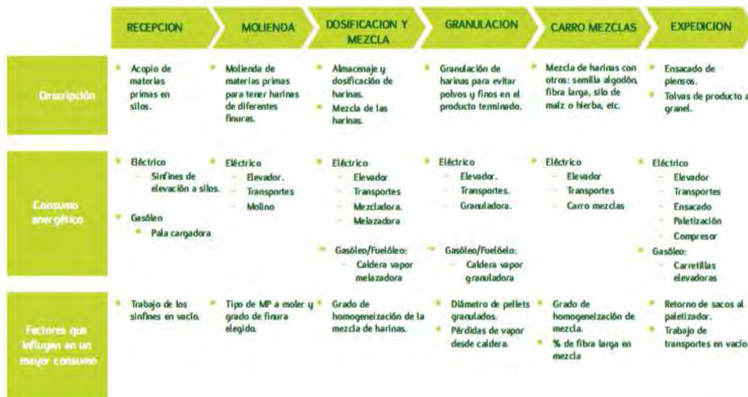
Ilustración 6. Principales consumos eléctricos de la fábrica (Sector Fábrica de Piensos)
