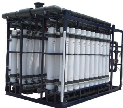
Bastidor y detalle de membranas de ultrafiltración
