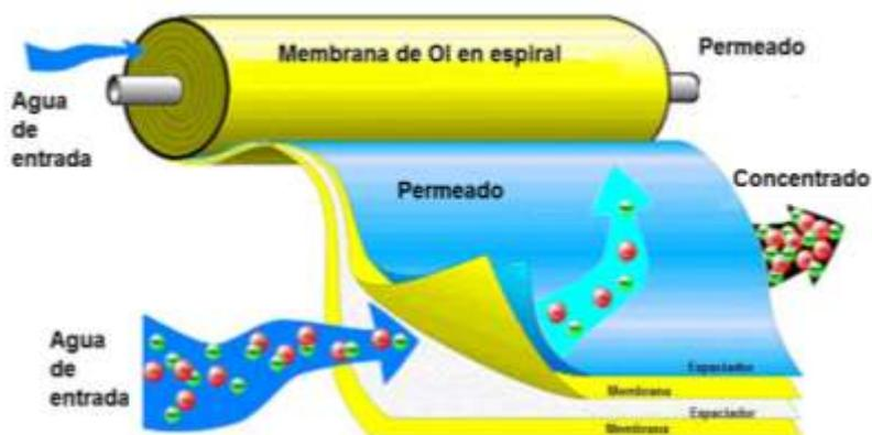
Figura 7.13. Esquema de una membrana de ósmosis inversa enrollada en espiral.
