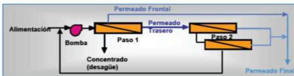
Figura 7.20. Esquema simplificado de las unidades de ósmosis del proceso.
