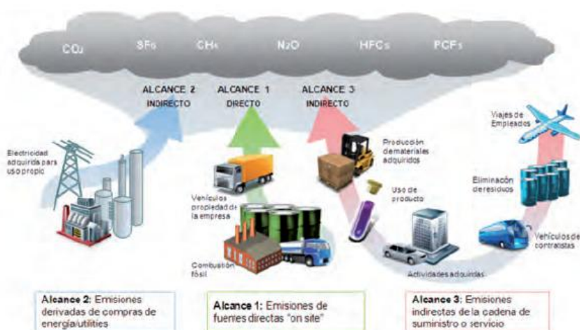
Imagen 7. Scopes de GHG Protocol y emisiones relacionadas (Observatorio de la Sostenibilidad en España (OSE), 2011 "Enfoques metodológicos para el cálculo de la Huella de Carbono").
